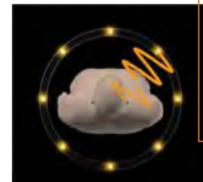
Schematische Darstellung der Ursachen für die Störung der B1-Homogenität bei höheren Feldstärken. Dielektrischer Resonanzeffekt, Skineffekt, stehende Welle.
