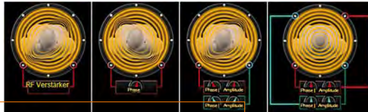
Schematische Darstellungen der Entwicklung der HF-Sendetechnologie bei Hochfeldsystemen: 1. Generation (normaler Quadratur-Birdcage) / 2. Generation (1 Sender mit variabler Phase) / 3. Generation (Multi-Transmit mit 2 Sendern und 2 Einspeisepunkten) / 4. Generation (Multi-Phase-Transmission mit 2 Sendern und 4 Einspeisepunkten)
