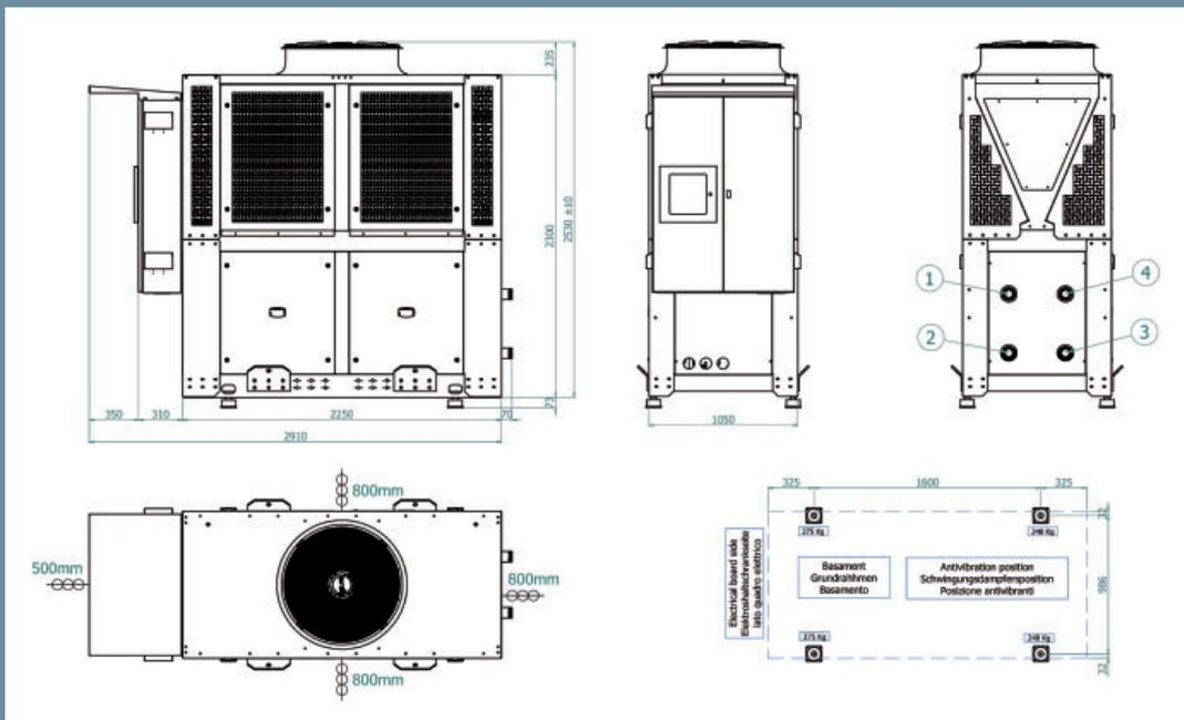
Kaltsoleerzeuger luftgekühlt R290 Außenaufstellung | Sole -8° C/-3° C | Kälteleistung 310 kW
